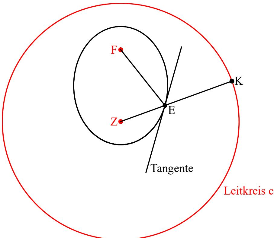
Liegt  $F$  innerhalb des Leitkreises  $c$ , bekommt man eine Ellipse. Diese besteht aus allen Punkten, die zu  $F$  und zu  $c$  gleichen Abstand haben. Die Konstruktion überträgt sich fast wörtlich:  $K$  wandere auf  $c$ ; die Mittelsenkrechte zu  $K$  und  $F$  schneidet  $ZK$  in einem Ellipsenpunkt  $E$  und ist Tangente zu  $E$ . Aus  $EF=EK=r-EZ$  folgt  $EF+EZ=r$ , also die übliche Ellipsen-Definition.
