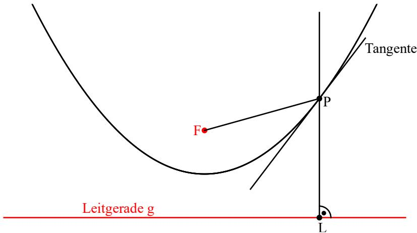
Eine Parabel besteht aus allen Punkten, die den gleichen Abstand zu einem Brennpunkt  $F$  und einer Leitgeraden  $g$  haben, wobei  $F$  nicht auf  $g$  liegt. Zur Konstruktion wandere  $L$  auf  $g$ ; die Mittelsenkrechte zu  $L$  und  $F$  schneidet die Senkrechte zu  $g$  durch  $L$  in einem Parabelpunkt  $P$  und ist Tangente zu  $P$ .
