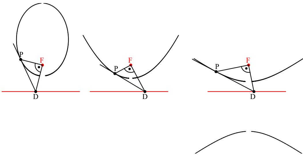
Damit lassen sich die Kegelschnitte und deren Tangenten einheitlich konstruieren.
