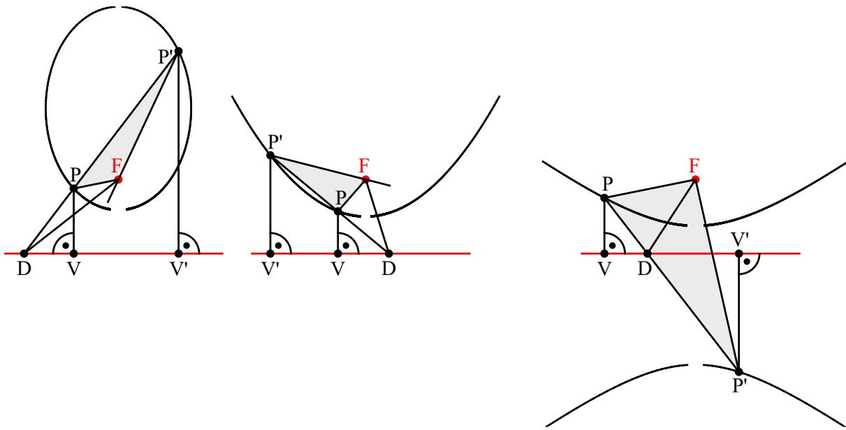
Wandert  $P'$  auf  $P$  zu, wird aus der Sekante  $PP'$  die Tangente in  $P$ . Sie schneidet  $g$  in  $D$ , die Winkelhalbierende zu  $FPP'$  durch  $F$  ist  $PF$ , und darauf steht  $DF$  senkrecht. Dies begründet die Tangenten-Konstruktion:
