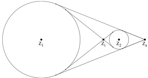
durch  $Z_i = \frac{r_2 \cdot Z_1 + r_1 \cdot Z_2}{r_1 + r_2}$  und  $Z_a = \frac{r_2 \cdot Z_1 - r_1 \cdot Z_2}{r_2 - r_1}$  bekommt.
